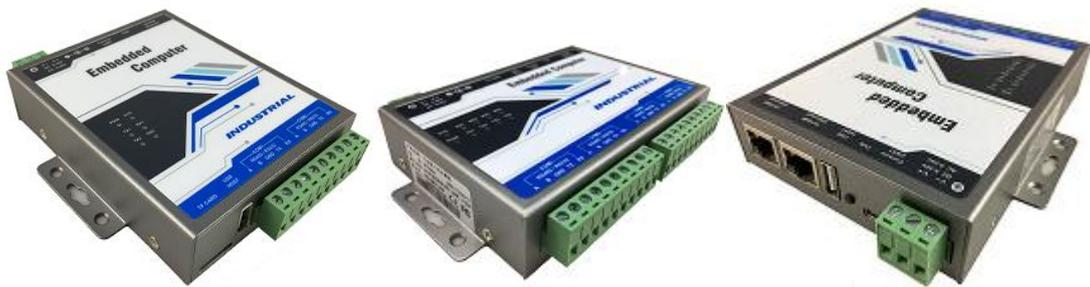
网关在应用现场通过接口和传感器、仪表、PLC 等设备连接，使用协议实时采集终端设备的运行数据，并把采集到的数据转换成水文 SL651 的协议格式发送到平台。
