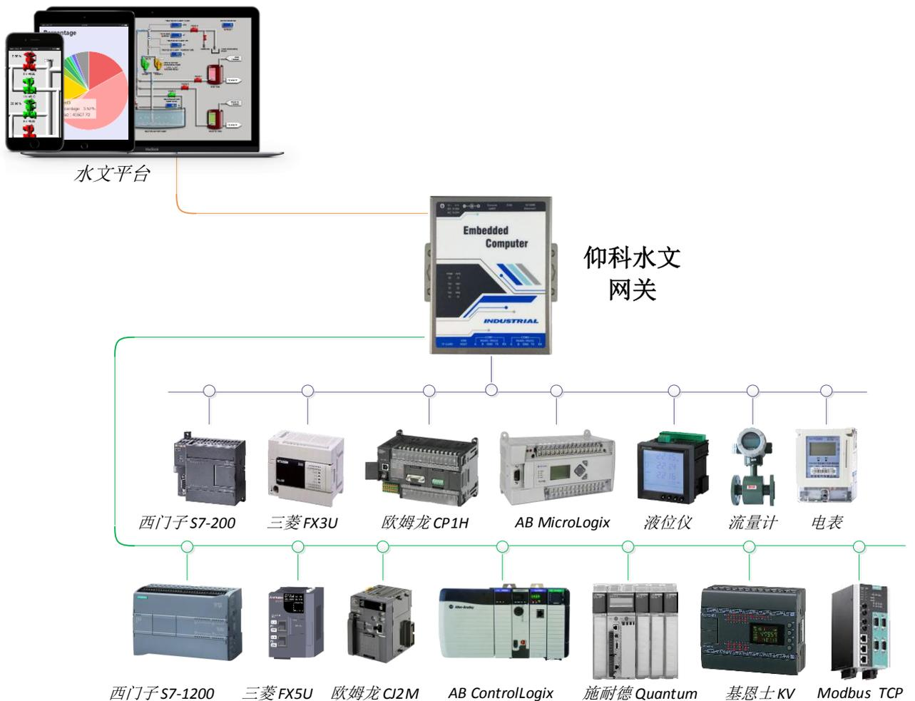
水文网关支持多种工业设备的通信协议，支持的通信协议（部分）如下。同时，网关还可以对采集的数据建立表达式，进行数学、逻辑判断等操作。
